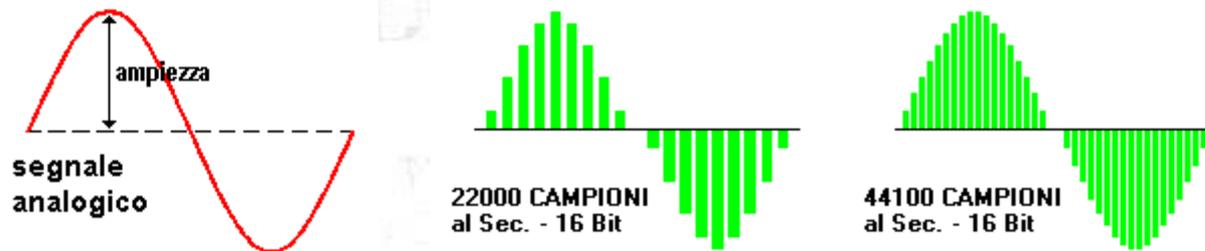
Ogni campione memorizzato rappresenta un'ampiezza ad un dato istante. Possiamo memorizzare ogni campione su un apposito supporto e successivamente, al momento della riproduzione, utilizzare un circuito che ritrasformi ogni campione nella corrispondente tensione elettrica; collegando il tutto ad un amplificatore ed un altoparlante, saremo in grado di ascoltare il suono originale.
