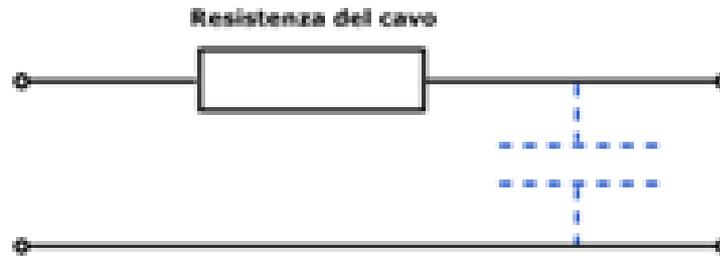
Inoltre, se i due conduttori sui quali si verifica questo fenomeno vengono spostati, durante la registrazione, la variazione di distanza tra quelle che si comportano come le piastre del condensatore, altera il valore della capacità generando così una corrente indesiderata.
